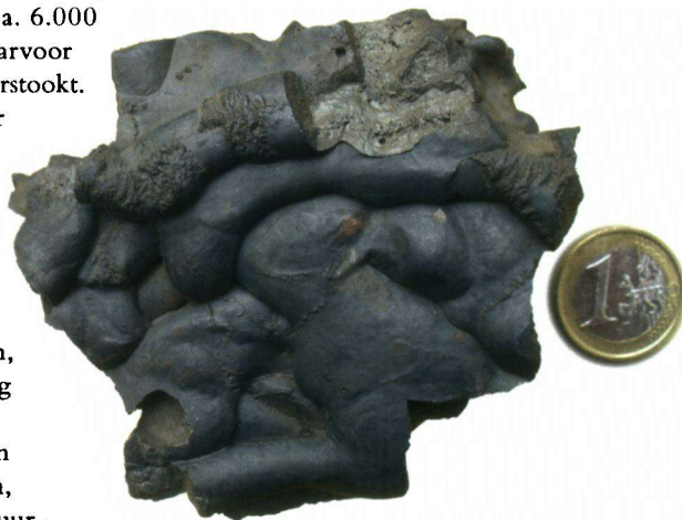
AFBEELDING 14. | Een ijzerslak uit het Montferland. De touwachtige vloeistructuur is goed te zien op het slakoppervlak.
