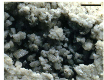
AFBEELDING 2. | Holte in een sinterafzetting met daarin sterk vergroeide kristallen. Reg. nummer 2417-2, maatstreep 1 mm.
