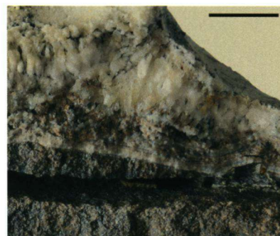
AFBEELDING 4. | Breukvlak van calcietsinter op zandsteen. Reg. nummer 2417-1, maatstrep 5 mm.
