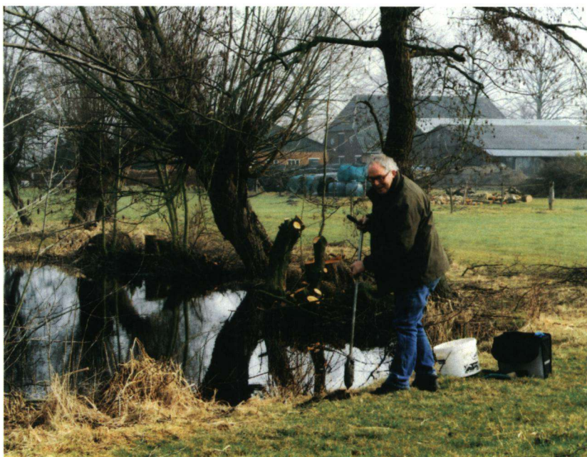
AFBEELDING 5. | Frans Roudijk brengt met zijn handboor de ondergrond naar boven.
