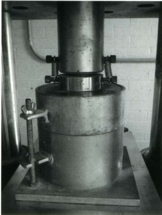
Afbeelding 5. De inhoud, inclusief de scaphopoden, van breedste cilinder werd flink onder druk gezet. De druk komt van boven van de smalle, massieve cilinder (gewijzigd naar Klompmaker, 2011).
