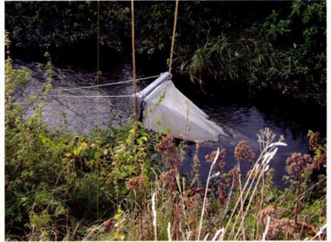
FIGUUR 3 Driftnet in de Hemelbeek voor het vangen van organismen die met de stroom meegevoerd worden (foto: Bart Brugmans).
