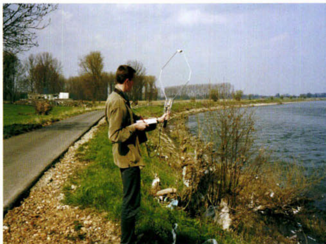
FIGUUR 3 Het lokaliseren van de gezenderde vissen met een radio-ontvanger en lusantenne, die de richting van het signaal bepaalt (foto: LUC-CMK, Peter Donders).
