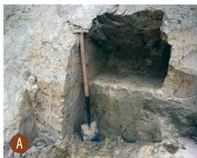
AFBEELDING 9. | Gedeformeerde graafgangen. A. meetlocatie van gedeformeerde graafgangen in de Oosterhout formatie. In de uitgespitte, kubusvormige kuil werden in drie oriëntaties ellipsen van graafgang-doorsneden gemeten, B. duidelijke oriëntatie van gedeformeerde graafgangen (zie de pijltjes voor een voorbeeld) wijst op deze locatie in de Jansen groeve op een sterke (subglaciale) deformatie en op overrijding van het landijs uit NW richting. Foto's: S.J. Kluiving.
