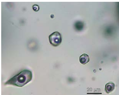
AFBEELDING 5. | Vloeistofinsluitels in kwarts van een granietpegmatiet onder de microscoop. De meeste insluitels bestaan hier uit vloeibaar water met een bel van waterdamp. De schaalbalk is 0,02 mm lang.
