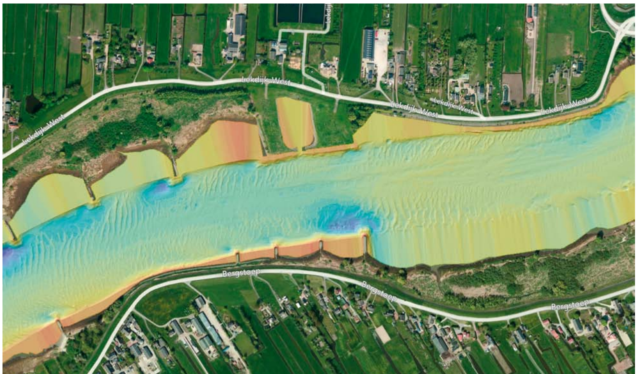
AFBEELDING 4. | Zandgolven op de bodem van de Lek bij Streefkerk. De stroom van de Lek gaat van rechts naar links, maar de zandgolven zijn met de lijzijde stroomopwaarts gericht. De blauwgekleurde gebieden zijn ontgravingen die achter de kribben ontstaan. (Opname: Rijkswaterstaat).
