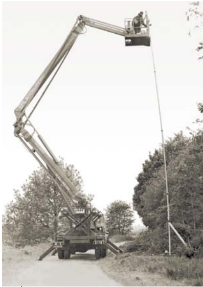
AFBEELDING 12. | Uitvoering van een temperatuurmeting van de ondergrond in een artesische peilput in Limburg. Doordat de stijghoogte in deze put tot ver boven het maaiveld uitkwam, moesten extra buizen worden gemonteerd om de meting mogelijk te maken.
