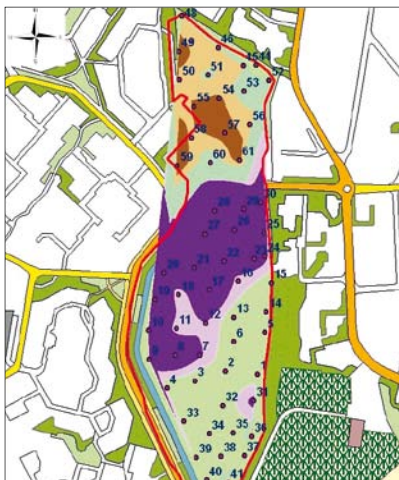
AFBEELDING 6. | Kartering van de verbreiding van veen (paars) en grind (bruin) in de ondergrond van het Gijzenveen. Boordiepte 1,2 meter. De grindlaag komt vooral in het noordelijk deel voor. Uit: Den Haan & Sevink, 2010.
