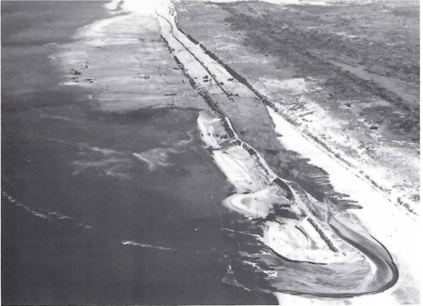
Zandsuppletie voor De Muij op Texel, oktober 1984. (Foto: Boskalis). Beach nourishment near De Muij on Texel.
