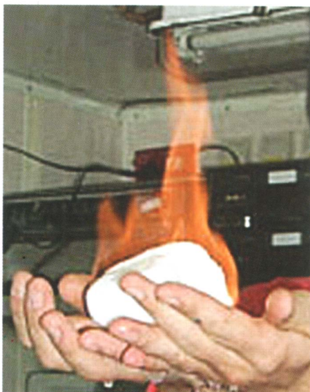
Figuur 9. Methaan-hydraat (aardgas in ijskristallen) wordt aan boord van het boorschip in brand gestoken.
