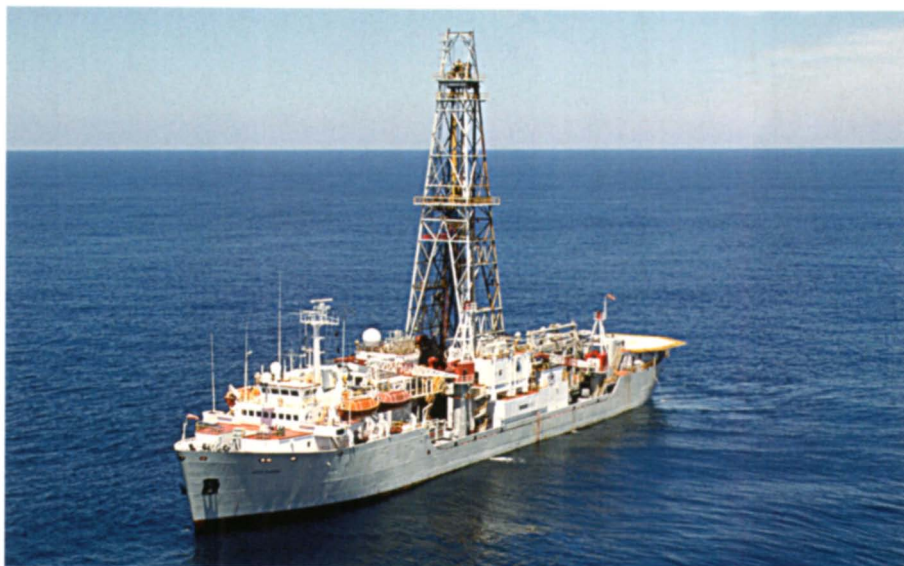
Figuur 5. Onderzoekschip JOIDES Resolution, 470 voet lang en 70 voet breed. De boorinstallatie op het schip torent 202 voet boven het water uit. Een computergestuurd positioneringssysteem met maar liefst 12 motoren houdt het schip op zijn plek tijdens boringen in de oceaانبodem tot maximaal 9 kilometer onder water.
