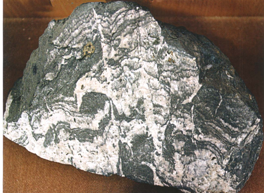
Figuur H - 3. Ertsmonster met uraninit (pebbleblende) en carbonaat (wit). Breedte handstuk ca. 15 cm (foto auteur).
