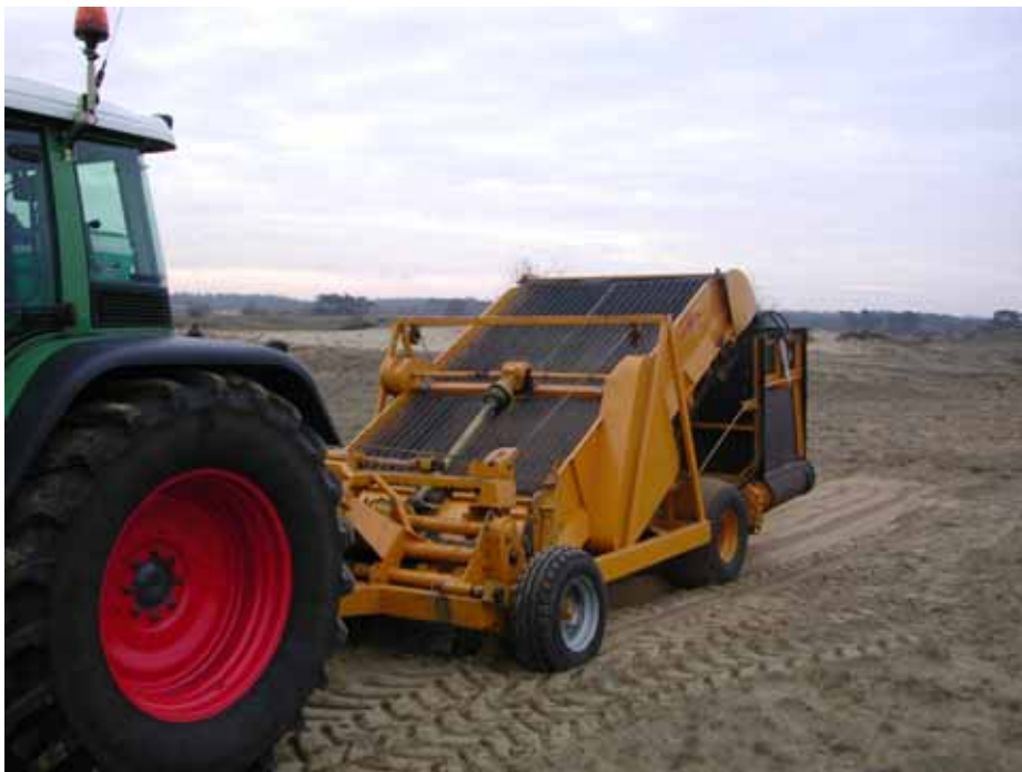
Figuur 2. De stuifzandreiniger voortgetrokken door een trekker (foto: Michel Riksen).
