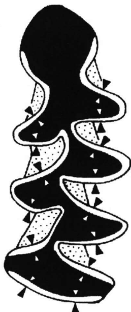
Fig. 5: De pijltjes geven de plaatsen aan waar de emaildikte gemeten wordt om een SDQ waarde te berekenen (naar HEINRICH, 1982).
