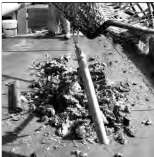
FIGUUR 2 KOR (SLEEPNET) MET DAARAAN BEVESTIGD DE ZOGENAAMDE MUIZENBUIZ WAARMEE BODEMSEDIMENT EN KLEINE FOSSIELEN OPGEVIST KUNNEN WORDEN. [FOTO: ANDRÉ SLUPIK]
