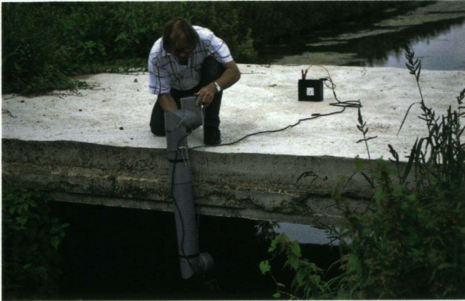
Met een proefmodel van een speciaal ontworpen periscoop worden nesten gecontroleerd. Met dit apparaat is het mogelijk om van bovenaf in de nesten te kijken, zonder het water in te hoeven gaan. Het apparaat is voorzien van een lamp die is aangesloten op een accu, zodat ook op donkere plekken kan worden gekeken. Foto: Wim Smeets.
