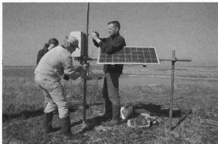
De opbouw van een automatische ontvanger voor zenderonderzoek.
