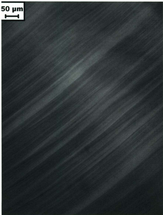
Afbeelding 6. Links: NaCl-kristallen voor en na plastische vervorming door verticale verkorting van 15% in een pers bij kamertemperatuur. De lijnen op het oppervlak van het vervormde kristal (rechts) zijn de sporen van een schuifbeweging langs prominente vlakken in het kristalrooster. Deze schuifbeweging vindt plaats doordat dislocaties door het kristal heen glijden (Afb. 7).
