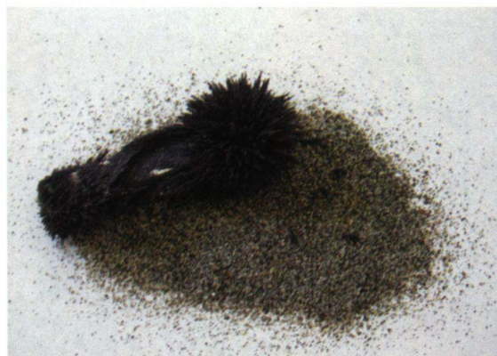
Afbeelding 2. Zand van het strand van St. Eustatius met zwarte titano- magnetietkorrels aan een staaf- magneet, en het achtergebleven witte koraalzand. Foto: Merle Laban.
