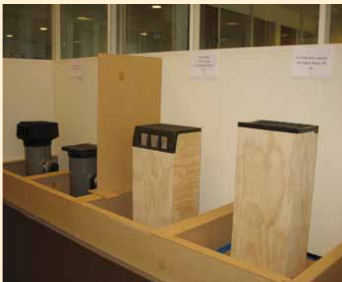
RAVON Proefopstelling straatkolken 2011. Vier verschillende kolktypen zijn getest met 4 algemeen in stedelijk gebied voorkomende amfibiesoorten. (Foto: Annemarie van Diepenbeek)
