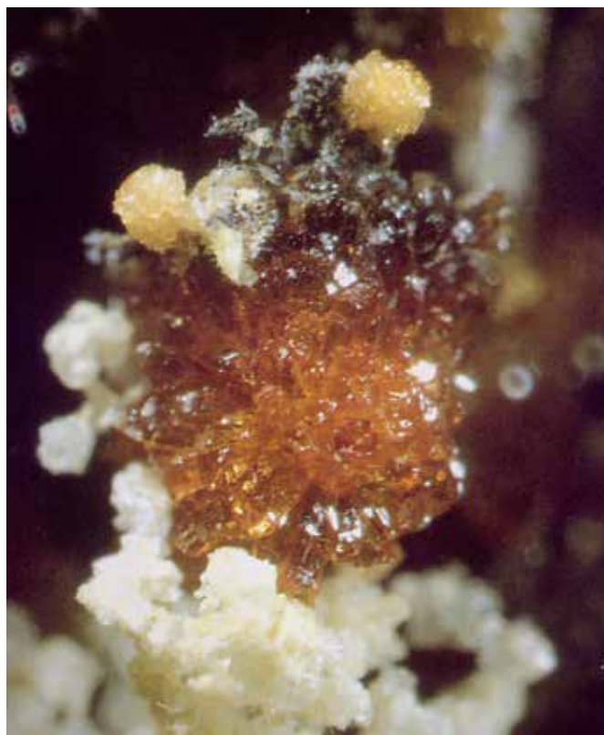
Afb. 7. Het resultaat van de omzetting van pyriet, in dit geval een gepyritiseerde ammoniet uit de Boulonnais (NW-Fr.), na enkele jaren verblijf in een ladenkast. Beeldhoogte 15 mm.
