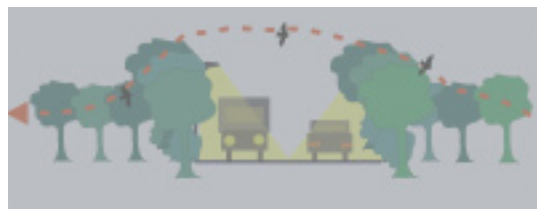
Figuur 7 Naar het wegdek gerichte, van boven afgeschermd, vleermuisvriendelijke verlichting in buitengebied. Tekening Herman Limpens.
