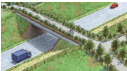
Figuur 4 Geleidingselementen naar en over viaduct.
